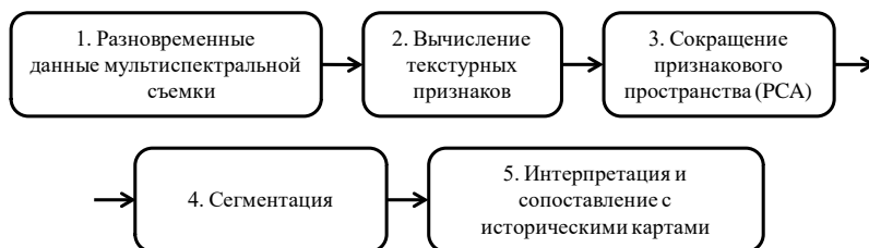
Рис. 3. Алгоритм обнаружения следов антропогенного преобразования природной среды
