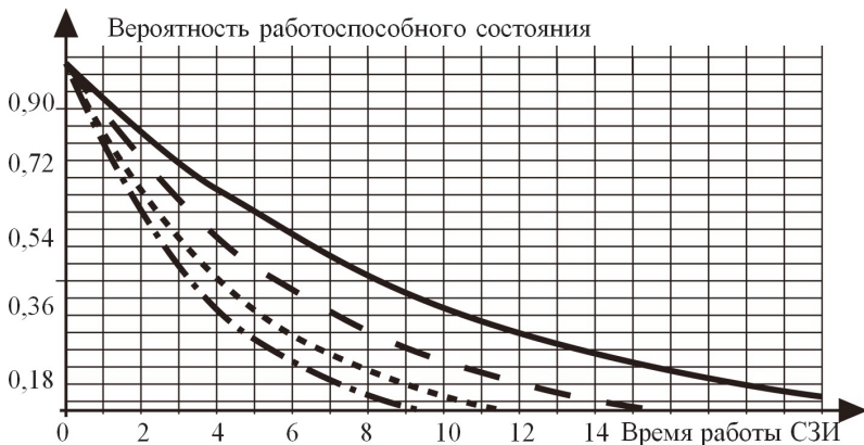
Рис. 19. Зависимость вероятности работоспособного состояния СЗИ от НСД от времени с исходным уровнем первичных ошибок \lambda_i = 10^{-5} , время работы СЗИ — 20 часов
