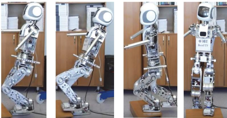
Рис. 12. Перешагивание робота через препятствие
