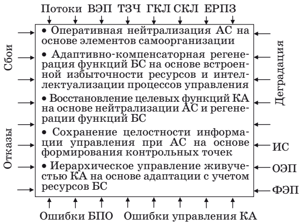
■ Рис. 2. Основные дестабилизирующие факторы и принципы нейтрализации их воздействия: ГКЛ — галактические космические лучи; СКЛ — солнечные космические лучи; ИС — интегральная схема; ОЭП — оптико-электронный преобразователь; ФЭП — фотоэлектрический преобразователь; БПО — бортовое программное обеспечение
