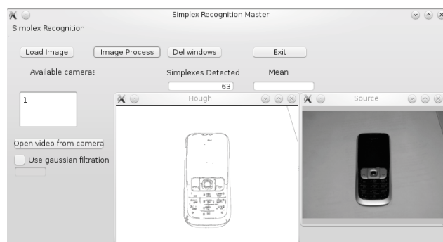
■ Рис. 1. Пример применения детектора границ Кенни с последующим выделением отрезков на основе преобразования Хафа
