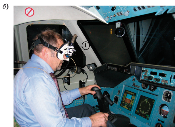
■ Рис. 1. Общий вид прибора NAC EMR: а — размещение в кабине ВС Ту-204; б — размещение на голове пилота: 1 — оптическая система метки глаза; 2 — записывающий адаптер (специальная видеокамера); 3 — ПЭВМ со специальным программным обеспечением
