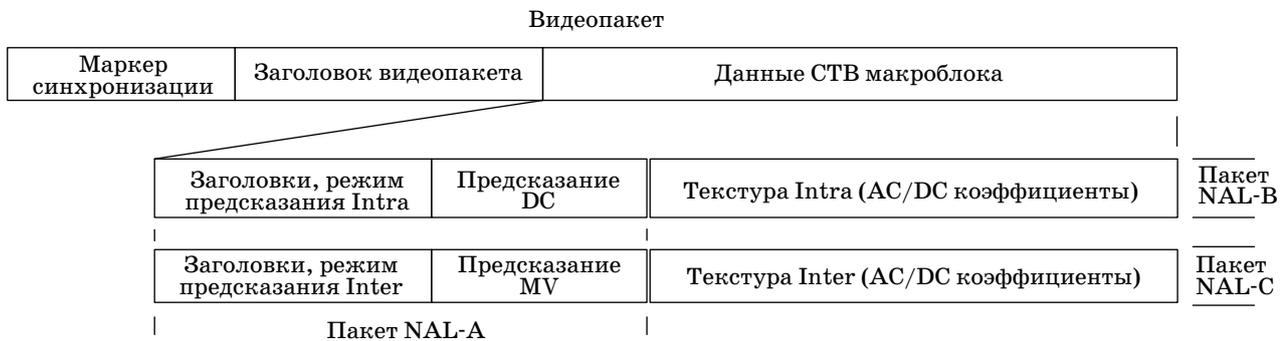
■ Рис. 4. Простейший вариант разбиения макроблоков
