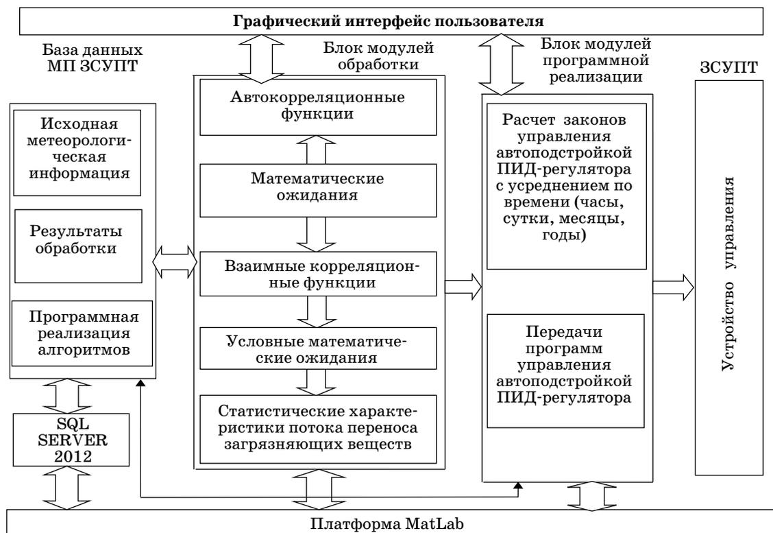
■ Рис. 2. Структура программного обеспечения подсистемы САИР МП ЗСУПТ
