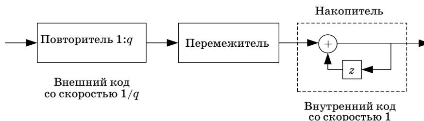
■ Рис. 8. Кодер RA-кода
