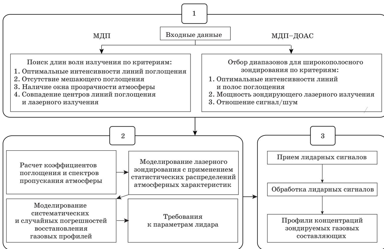
■ **Рис. 1.** Схема методики планирования и проведения лидарных МДП–ДОАС-измерений
