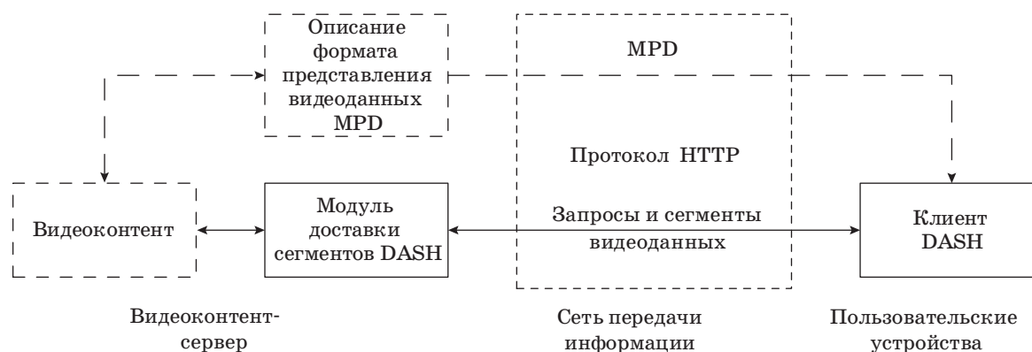
■ Рис. 1. Структура системы передачи видеоданных на основе стандарта DASH: MPD — формат Media Presentation Description
