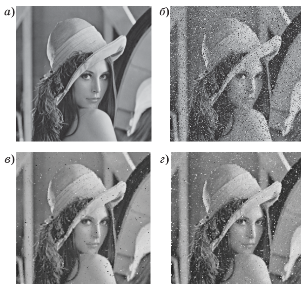
■ Рис. 4. Результаты применения фильтра к изображению «Lena» с уровнем шума p = 20\% : a — исходное изображение; б — зашумленное изображение; в — изображение, восстановленное предложенным фильтром; г — изображение, восстановленное медианным фильтром
