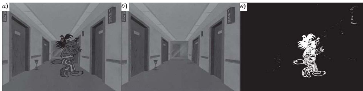
■ Рис. 7. Создание заготовки силуэта движущегося объекта: а — исходное изображение, включающее в себя движущийся объект (волка) и фоновую часть; б — фоновое изображение; в — изображение заготовки силуэта
