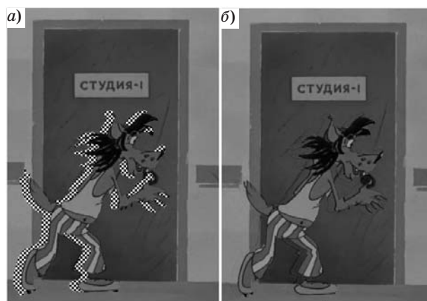
■ Рис. 3. Результаты конвертации 2D-изображения в 3D-формат для левого компонента стереоскопического изображения, на котором области открытия видны ( а ); заполнены фрагментами фонового изображения ( б )
