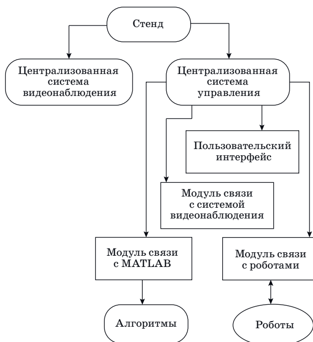
■ Рис. 1. Взаимодействие модулей стенда ■ Fig. 1. Interaction of framework modules
