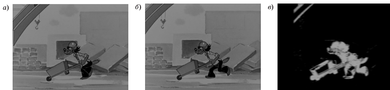
■ Рис. 5. Текущий (а) и предшествующий (б) кадры и карта глубины (в) в методе конвертации, основанном на использовании фактора движения при формировании карты глубины в случае движения камеры
