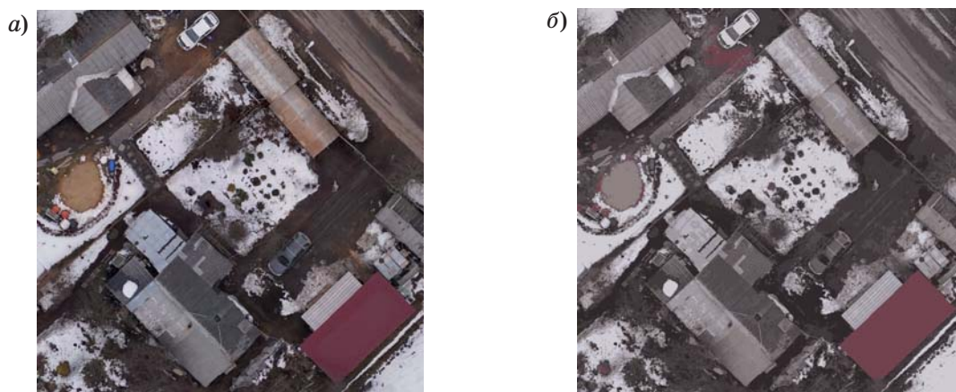
■ Рис. 2. Результаты кластеризации изображения-эталона: а — исходное ТВ-изображение-эталон; б — сегментированное на 10 кластеров изображение-эталон ■ Fig. 2. Clustering results of sample image: а — initial visible sample image; б — segmented into 10 clusters sample image
