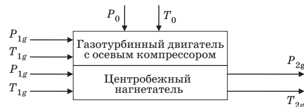
■ Рис. 2. Схема связи параметров газа в ГПА
