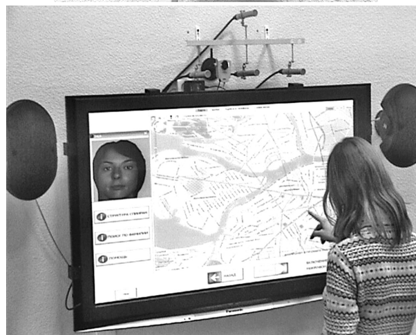
■ Рис. 4. Прототип массива микрофонов для «интеллектуального зала» СПИИРАН
