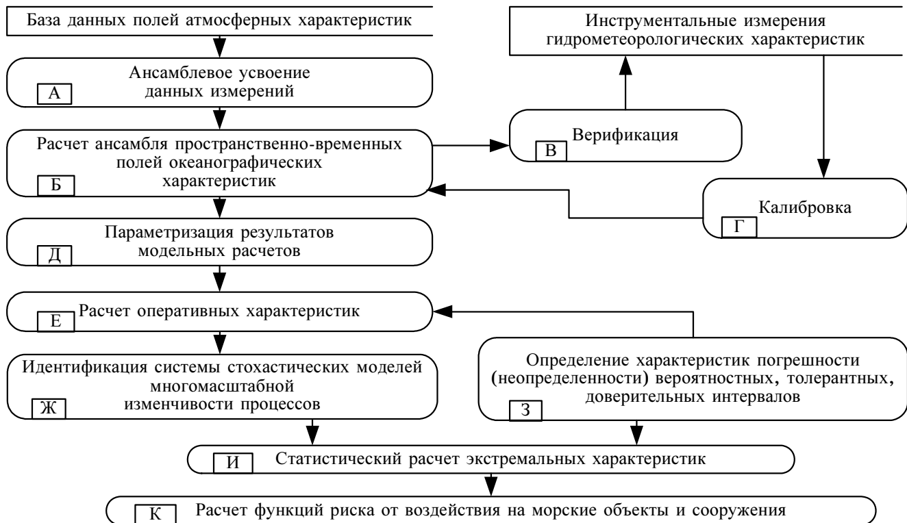
■ Рис. 1. Функциональная схема программного комплекса моделирования экстремальных гидрометеорологических явлений
