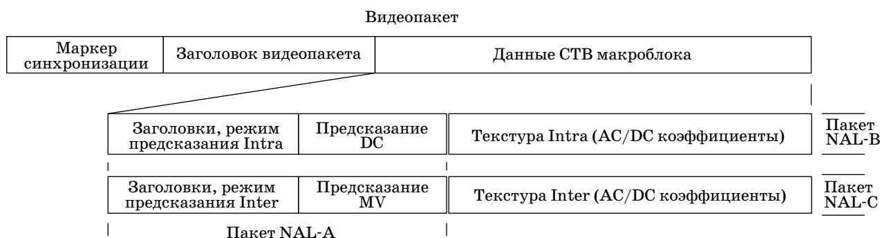
■ Рис. 4. Простейший вариант разбиения макроблоков
