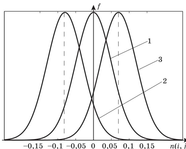
■ **Рис. 1.** Нормальный закон распределения: 1 — исходная кривая распределения ( $m(i) = 0$ ); 2, 3 — кривые распределения после моделирования ( $m(i)$  — расчетное)
