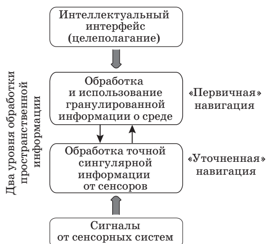
■ Рис. 5. Иерархическая схема информационного взаимодействия когнитивного агента со средой
