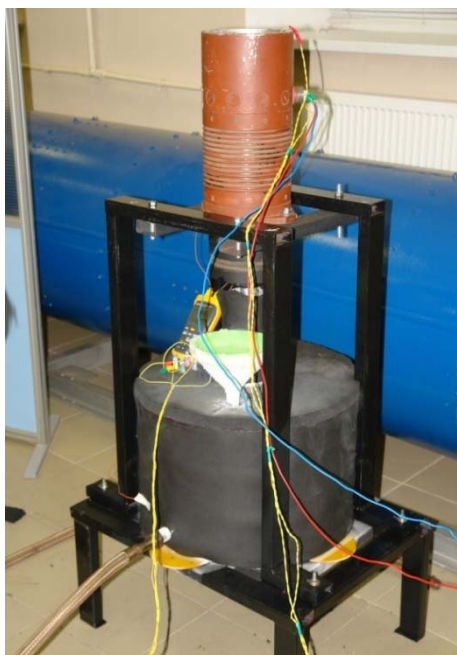
■ Рис. 3. Сверхпроводниковый ветрогенератор мощностью 5 кВт
