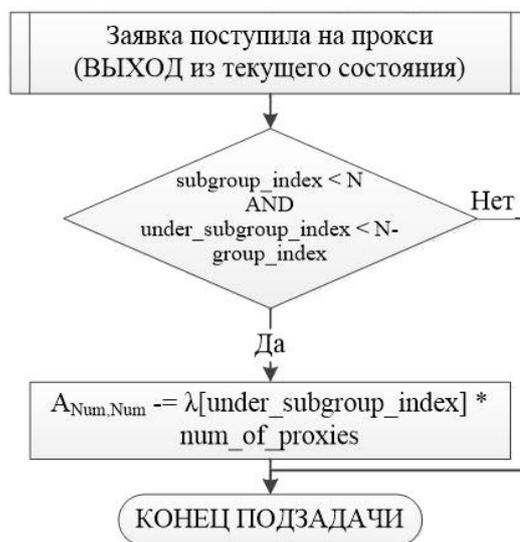
Рис. 6. Блок-схема алгоритма подзадачи, выход из состояния при поступлении заявки на прокси
