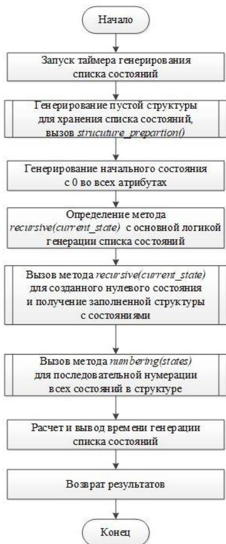
Рис. 2. Блок-схема с описанием шага генерирования списка состояний
