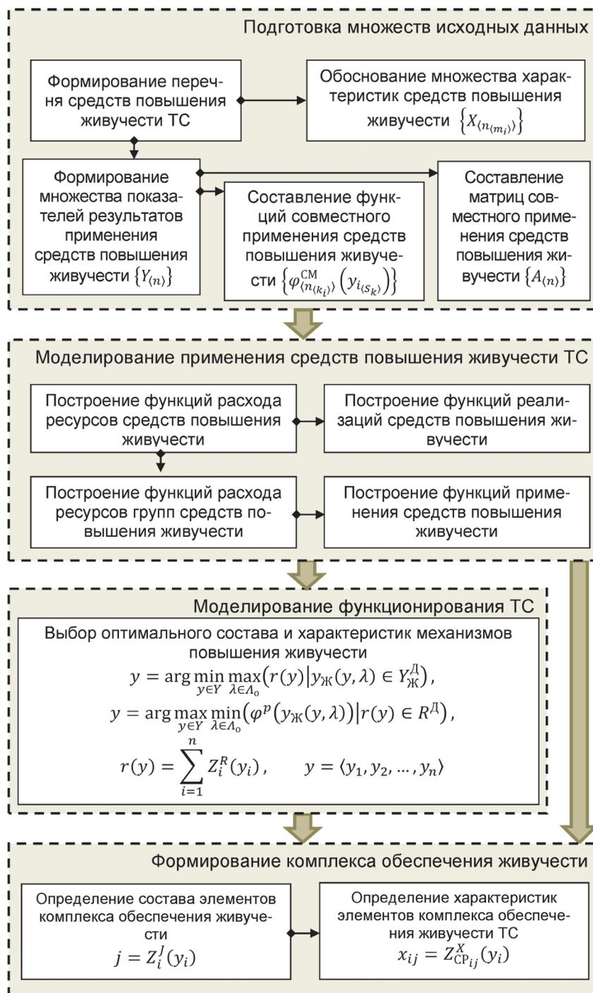
Рис. 4. Алгоритм структурно-параметрической оптимизации комплекса обеспечения живучести структурной системы
